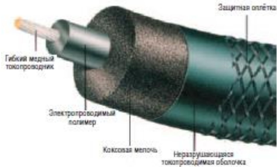
Рисунок 1 Протяженный гибкий анод 1 – металлический проводник, 2 – электропроводный полимер, 3 - токопроводящая засыпка, 4 – рукав из углеродной ткани
